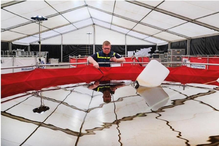
Die Trinkwasseraufbereitungsanlage des THW kann in einer Stunde 15.000 Liter Rohwasser in frisches Trinkwasser verwandeln. (Foto: THW/Kai-Uwe Wäerner)
